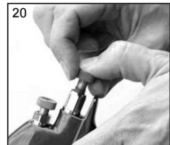
20. Installer le ressort (8) et le bouton (7).
