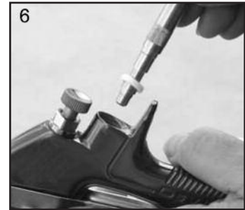
6. Retire el asiento de la válvula.
