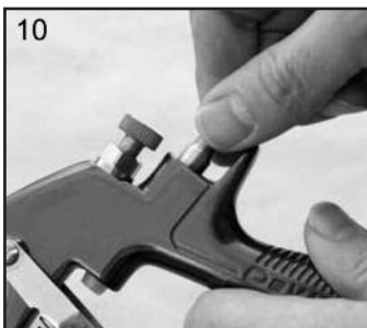
10. Coloque la junta nueva sobre el cuerpo de la pistola y empuje firmemente para asegurarse de que la junta quede correctamente colocada.
