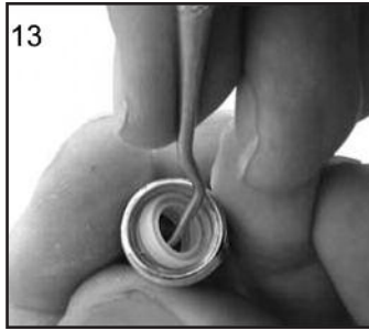
13. Retirer le joint arrière de la soupape d'air du boîtier (10) à l'aide d'un crochet.
