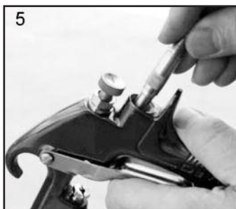
5. À l'aide de l'outil d'entretien SPN-7, saisir la rainure derrière le support de la soupape.
