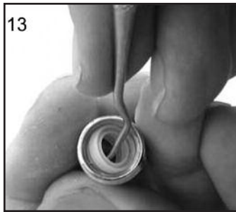
13. Retire la junta de la válvula de aire del alojamiento (10) con un instrumento que tenga gancho.
