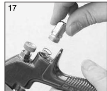
17. Remplacer le ressort de soupape en introduisant la petite extrémité du ressort dans le pistolet, et le visser dans le boîtier (10).
