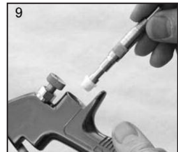
9. Instale una junta delantera nueva en la herramienta de mantenimiento de manera que la muesca quede orientada hacia el extremo con mango de la herramienta.
