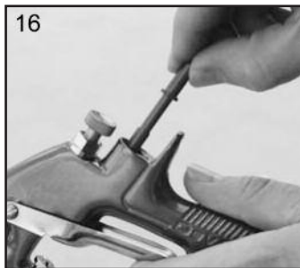
16. Replacer la soupape (11).
