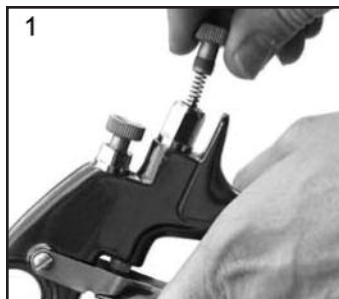
1. Retirer le bouton de réglage (7), le ressort (8) et le pointeau (9).
