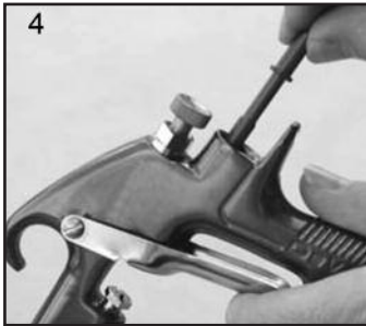
4. Retire la válvula (11).
