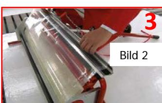
Rollen Sie ca. 30 cm der Colad Film4Booth Folie ab. Befestigen Sie den Rollenanfang in der Klemmleiste des Colad Film4Booth Applikators (Bild 3).
