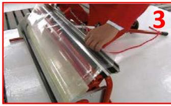
Srotolare circa 30 centimetri del Film4Booth Colad. Posizionare il bordo superiore del Film4Booth Colad nel meccanismo dell'applicatore Film4Booth Colad (figura 3).
