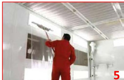
Wenn Sie den Kabinenboden erreicht haben, drücken Sie den Klappbügel des Abrollers Richtung Wand nach unten und schneiden die Folie am Boden ab. (Bild 6-7).
